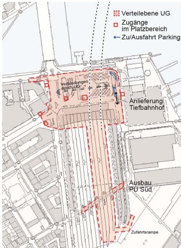
Abbildung 3: Schnittstellen zwischen Verkehr+Umfeld und Infrastruktur Tiefbahnhof
